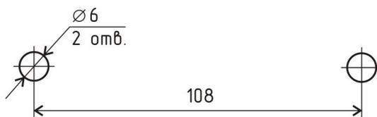
*Рисунок 9 - Шаблон для сверления отверстий крепления*
